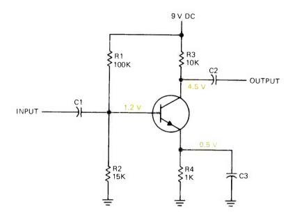
FIGURE 2. A TYPICAL COMMON-EMITTER NPN AMPLIFIER.
