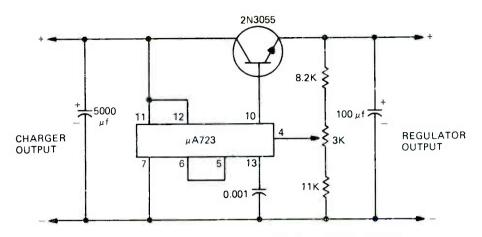
FIGURE 2. REGULATOR HUNG ACROSS CHARGER OUTPUT.
