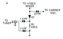
Fig. 17. Diode modulator.
