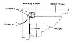
Fig. 6. Simple door switch.
