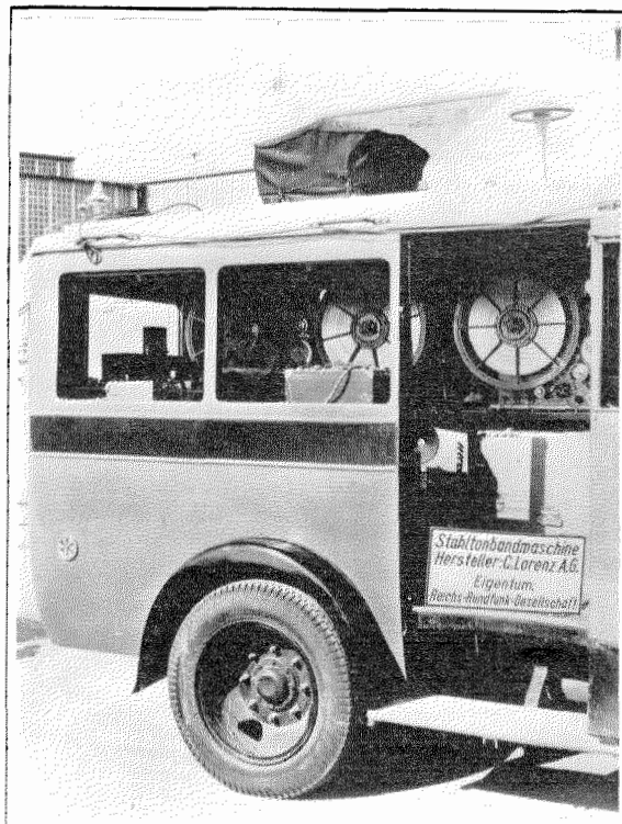
Fig. 15—Lorenz Steel Tone Tape Machine of the Reichsrundfunk-Gesellschaft.
