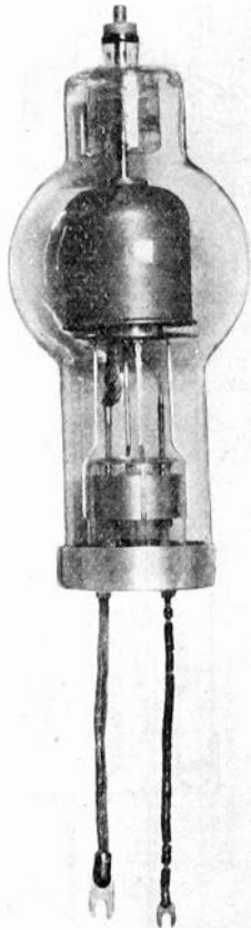
Fig. 2—Hot-cathode mercury-vapor rectifier tube, Radiotron RCA-870.
