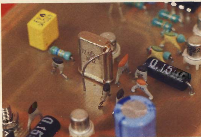
Photo 7. Le boîtier du quartz d'émission rejoint la masse par un strap.
