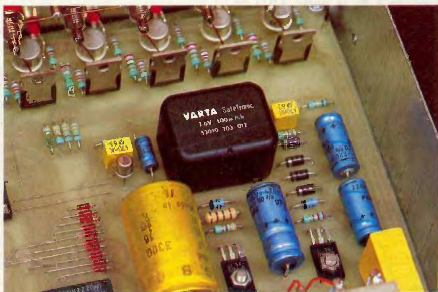
L'accumulateur de sauvegarde 3,6 V-100 mAh.
