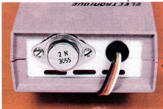
Mise en place du 2N3055 de puissance.
