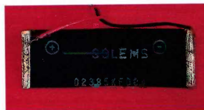
La cellule se soude directement sur les parties réservées à cet effet.
