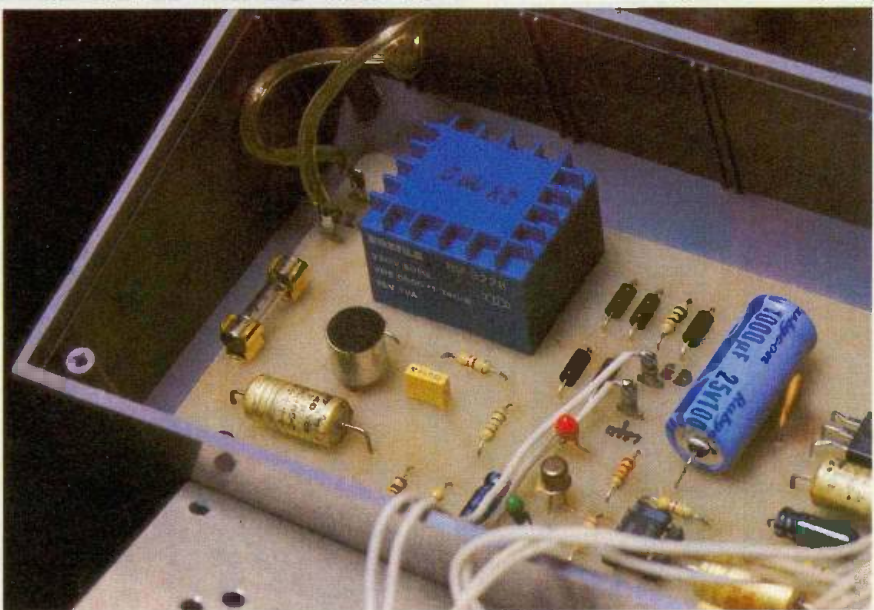
On aperçoit, à côté du transformateur bleu, le micro.
