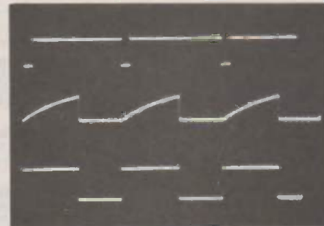
Oscillogramme L. — Exemple d'utilisation du commutateur, avec un oscilloscope bicourbe. En haut : signal de déclenchement d'un 555 ; au milieu, rampes prélevées sur le condensateur de temporisation ; en bas, créneaux disponibles à la sortie (borne 3).
