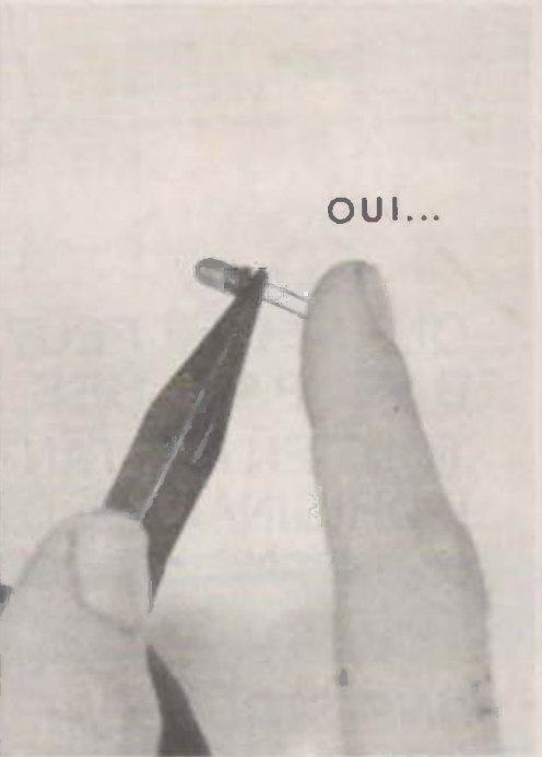
Photo 2: — Le pliage des pattes d'une LED demande certaines précautions.
