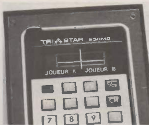
Photo 4. — Modification de l'afficheur de la calculatrice avec des lettres transfert.
