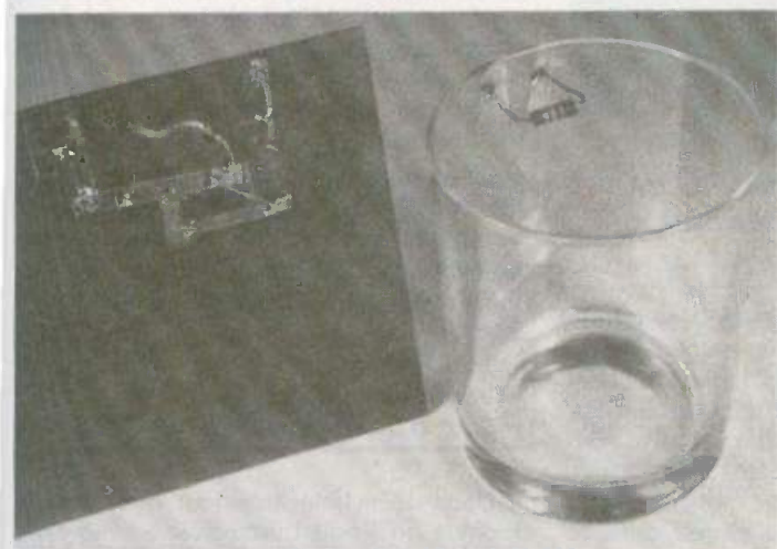
Photo 6. Avec la feuille métallique adhésive et soudable, on peut fixer des circuits électroniques sur n'importe quel isolant.
