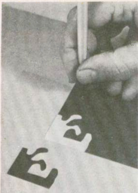
Photo 3. — La plage de masse est décalquée puis découpée dans l'adhésif Normapaque.
