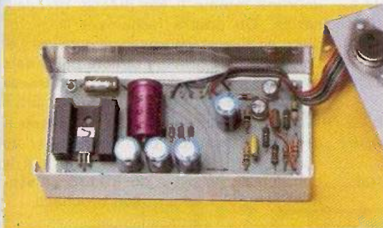
Le convertisseur 6/12 V sans transformateur.
