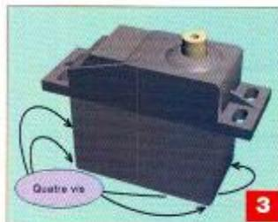
Démontez préalablement le palonnier. Ensuite, repérez les quatre vis, situées sous le servomoteur, elles maintiennent les trois parties du boîtier. Dévissez-les en utilisant un tournevis bien adapté et en tenant le servomoteur verticalement afin d'éviter
