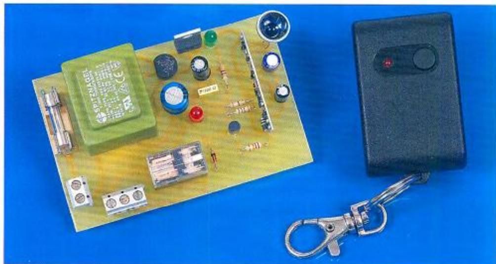
Nous avons détourné, de leur utilisation première, deux modules de gestion infrarouge prévus, à l'origine, pour la réalisation d'une barrière destinée à un éclairage automatique, à l'ouverture d'une porte ou au déclenchement d'un système d'alarme.
