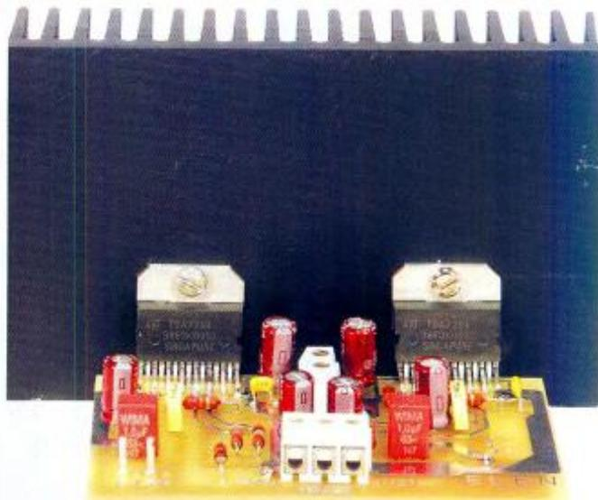
de monter deux TDA7294 en pont, comme l'indique le schéma électrique proposé en **figure 1**.
