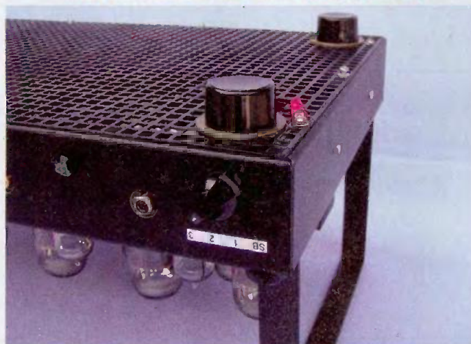
Photo 8 : Le raccordement à la masse se fait en un seul point de fixation de la grille de protection (en bas, à droite, à côté du pied)
