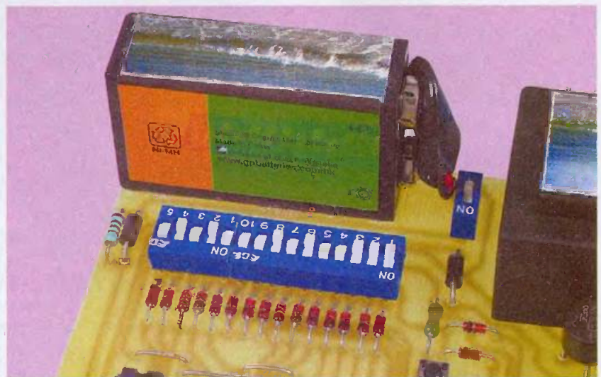
Le bloc DIL de 15 interrupteurs permet d'établir les liaisons de programmation
