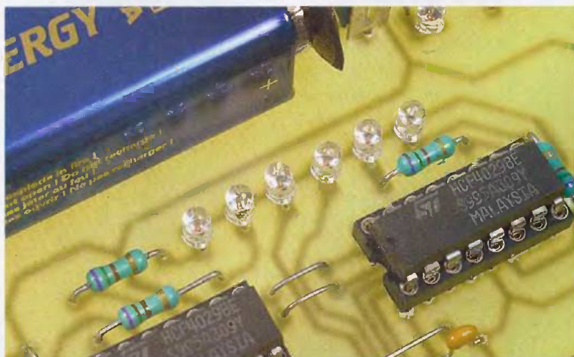
Des diodes LED signalent l'état binaire des sorties Q des compteurs CD4029
