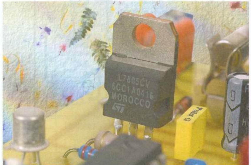
Le régulateur ne dispose pas de dissipateur
