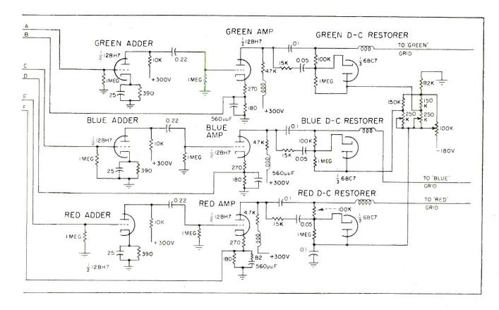
$$\begin{split} E'_{Y} &= 0.59 E'_{G} + 0.30 E'_{R} + 0.11 E'_{B} \\ E'_{I} &= 0.74 (E'_{R} - E'_{Y}) - 0.27 (E'_{B} - E'_{Y}) \\ E'_{Q} &= 0.48 (E'_{R} - E'_{Y}) + 0.41 (E'_{B} - E'_{Y}) \end{split}$$
