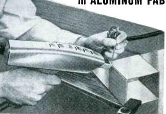
"THE MULLARD ULTRASONIC SOLDERING IRON''
