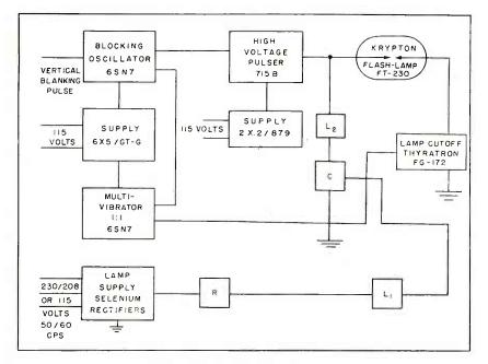
FIG. 4-Synchro-Lite block diagram
