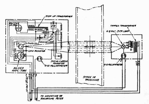
CIRCUITS OF PHOTO-ELECTRIC SMOKE RECORDER
