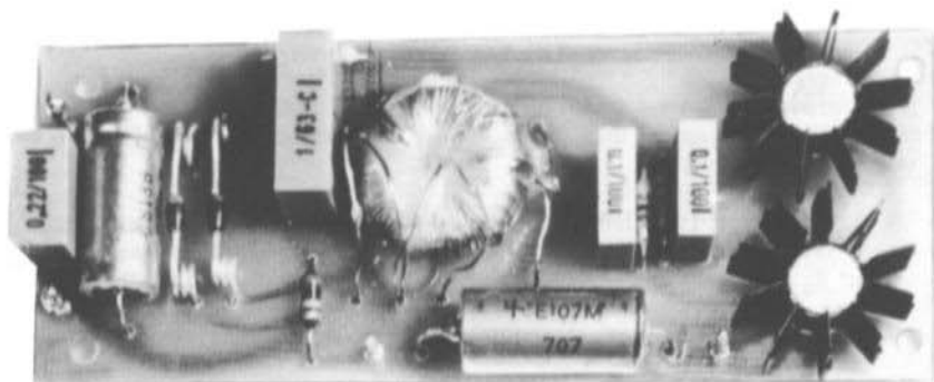
Fig. 1: 12 W DC-DC converter 12 V/28 V DK 1 PN 001
