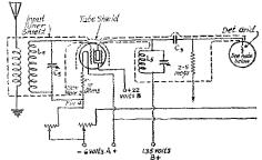
SHIELD-GRID METHOD GURE 5. THE SHIELD-GRID METHOD USING THE TUBE AS AN R.F. AMPLIFIER
