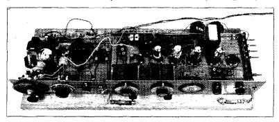
THE SUPERHETERODYNE VERSUS-AUDIO RECEIVER USED FOR DEMONSTRATION
