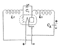
FIG. 15-THE HETERODYNE OSCILLATOR CIRCUIT
