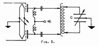
THE MOVABLE PLATES OF THE CONDENSER AT GROUND POTENTIAL SO THAT THE CIRCUIT IS NOT DETUNED BY BODY CAPACITY TO GROUND WHEN THE HAND IS PLAC-ED ON THE DIAL, WHICH OF
