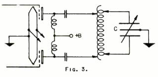
THE MOVABLE PLATES OF THE CONDENSER AT GROUND POTENTIAL SO THAT THE CIRCUIT IS NOT DETUNED BY BODY CAPACITY TO GROUND WHEN THE HAND IS PLAC-ED ON THE DIAL, WHICH OF
