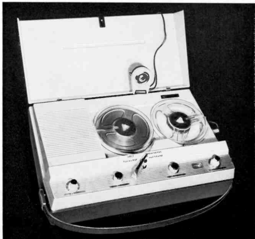
Bild 7 Befindet sich der Netzstecker in der Ruhalterung, so ist das Gerät automatisch auf Batteriebetrieb umgeschaltet.
