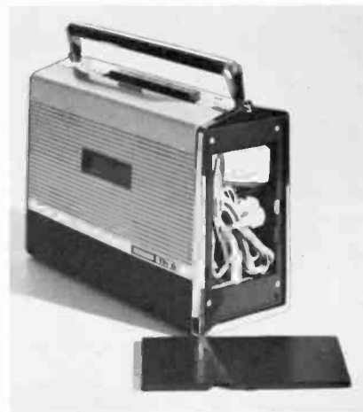
Bild 6 Nach Abnahme der rechten Seitenklappe ist das Fach für Mikrofon und Netzschluß zugänglich.
