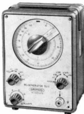
RC-Generator TG 11 (Frequenzen: 10 Hz ... 300 kHz in 5 Bereichen; Eigen-Klirrfaktor < 0,5%)
