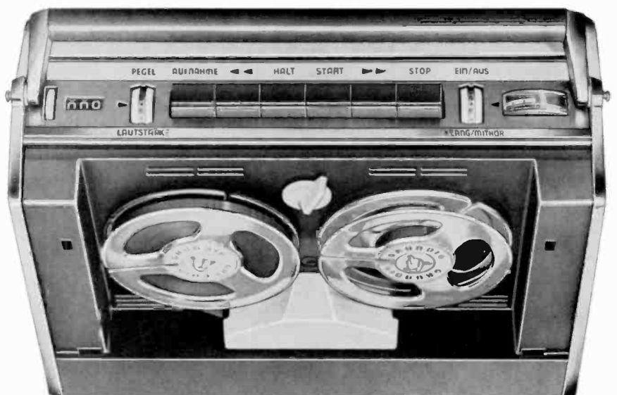
Bild 13 Die Bedienungsriffe des TK 6. Der mittlere Knebelknopf (oben zwischen den Spulen) dient zur Bandgeschwindigkeits-Umschaltung.
