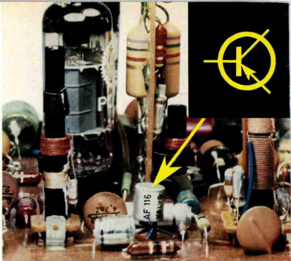
Bild 1 Anordnung des Transistors AF 116 im Ton-ZF-Verstärker des FT 205
