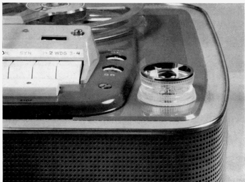
Bild 5 Die entkoppelbaren Skalenscheiben-Drehknöpfe des Zweikanal-Lautstärkereglers
