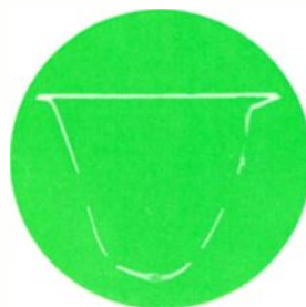
Bild 5 „Marke“ (Schwebung) auf einer HF-Durchlaßkurve. RC-Kombination 5 k \Omega - 1 nF vor dem Oszillographeneingang
