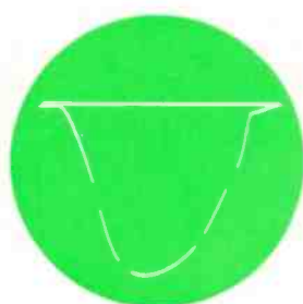
Bild 9 Der Abschlußwiderstand des Wobblers-HF-Kabels fehlt
