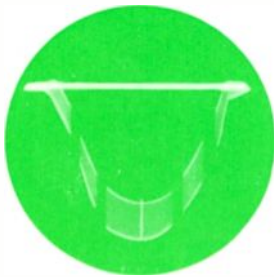
Bild 4 „Marke“ (Schwebung) auf einer HF-Durchlaßkurve mit Breitbandoszillograph
