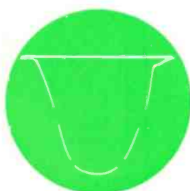
Bild 12 Durchlaßkurve eines Bild-ZF-Verstärkers vor dem Vertauschen der Röhren
