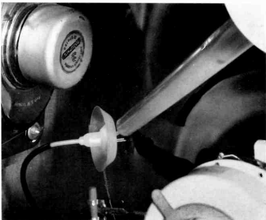
▼ Jetzt können bei hineingestecktem Hochspannungsanschluß die Federdrähte mit der Hochspannungstastspitze (Typ 245; 30 kV) mühelos berührt werden.
