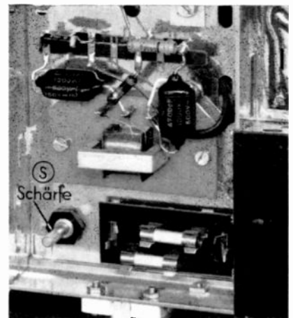
▲ Bild 4 Die Anordnung der Schaltungs-Einzelteile im Mittelfeld des Fernsehgerätechassis.
