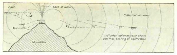
FIG. 4. UTILIZATION OF THE SIMON SYSTEM FOR COLLISION WARNING.
