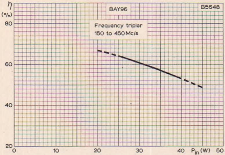
TYPICAL TRIPLER EFFICIENCY PLOTTED AGAINST INPUT POWER
