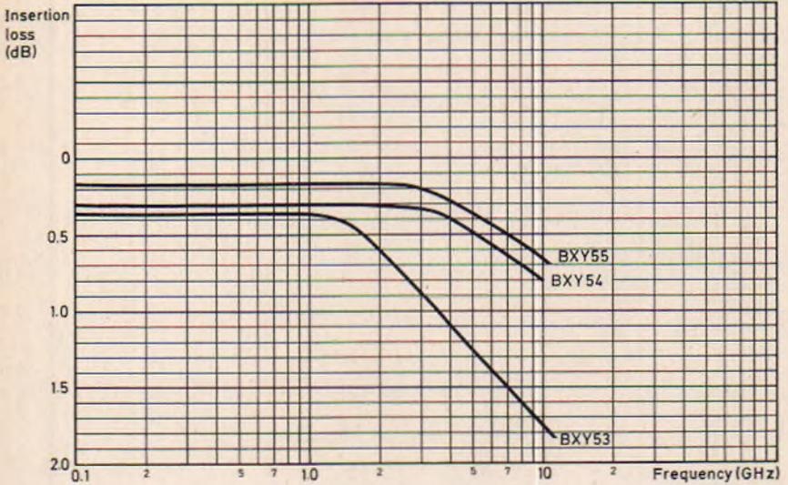
TYPICAL INSERTION LOSS AS A FUNCTION OF FREQUENCY
