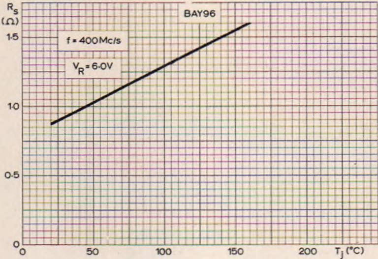
TYPICAL DIODE CAPACITANCE AND SERIES RESISTANCE PLOTTED AGAINST JUNCTION TEMPERATURE
