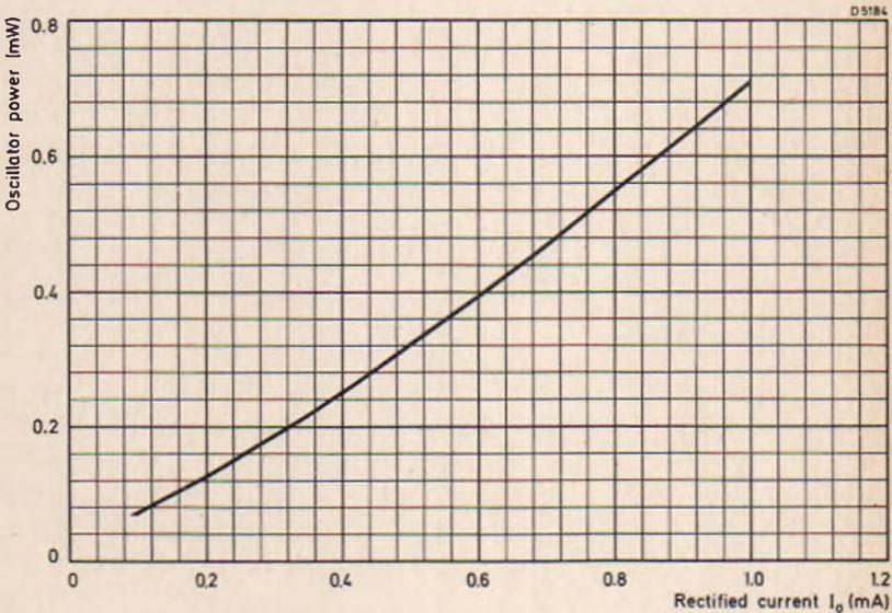
TYPICAL RECTIFIED CURRENT AS A FUNCTION OF LOCAL OSCILLATOR POWER
