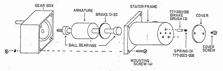
JAPAN SERVO CAROUSEL MOTORS - TRAY SHIFT 775 0012 000 (VRM6P4w/6G60H/6G50H GEAR BOX) ROTATE 775 0013 000 (VRM6P4w/6G150H GEAR BOX)
