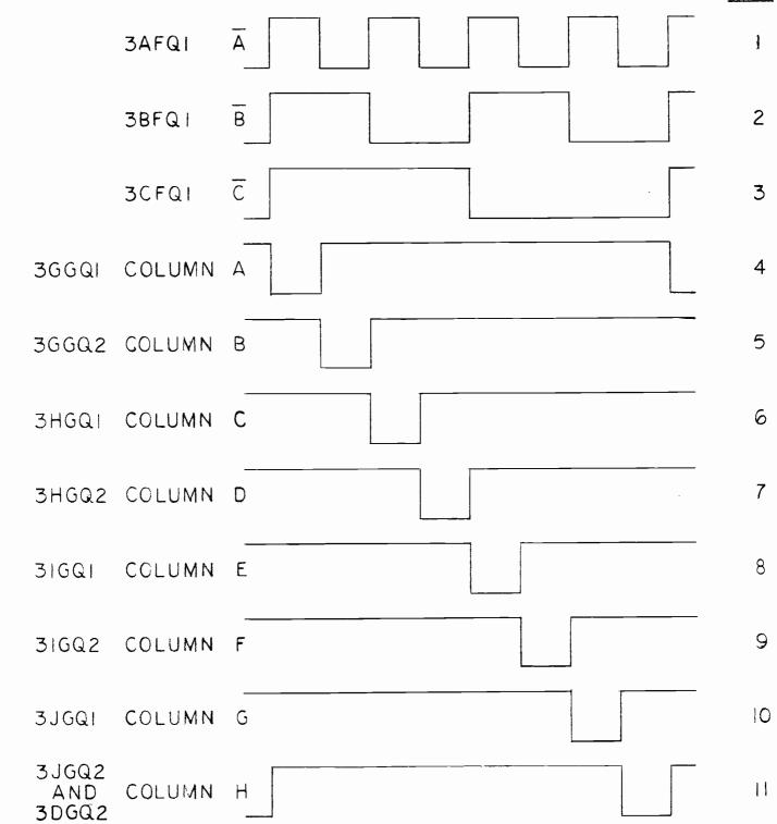
MODULE 3 COLUMN DISTRIBUTOR WAVEFORMS DT-120 FIGURE 10B
