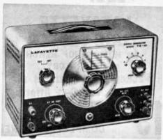
• FACTORY CALIBRATED AND TESTED • SIX BANOS: 120 KG - 260 MC
