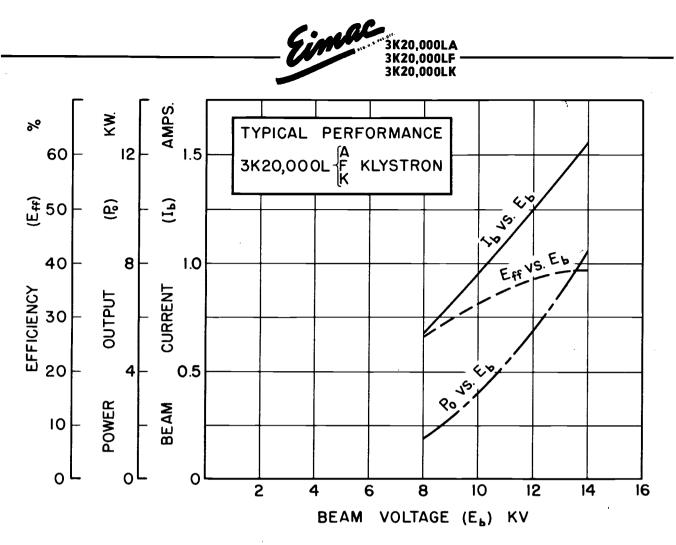
BEAM CURRENT, POWER OUTPUT AND EFFICIENCY VERSUS BEAM VOLTAGE
