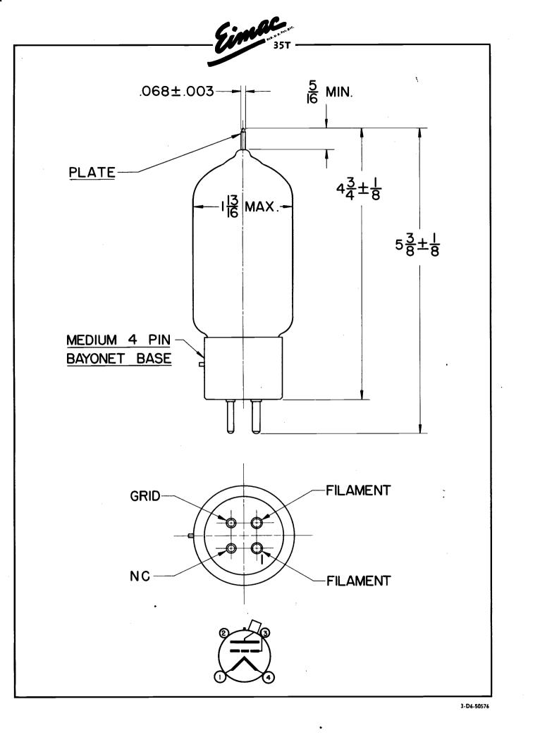
HIGH-MU TRIODE MODULATOR OSCILLATOR AMPLIFIER
