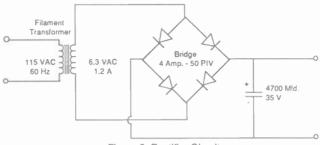
Figure 2. Rectifier Circuit.
