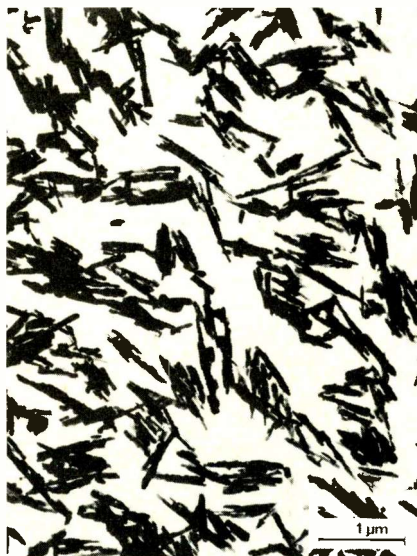
Fig. 2 — Particles used in TDK SA tape.
