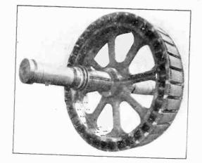
FIG. 12-ROTOR WITH CAST STEEL SPIDER
