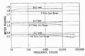
FIG. 9—FREQUENCY CHARACTERISTIC OF VACUUM TUBE Voltmeter
