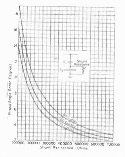
FIG. 10-PHASE-ANGLE CHARACTERISTICS OF CAPACITANCE TRANSFORMERS
