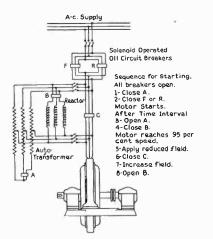
FIG. 14—ELEMENTARY DIAGRAM OF COMBINATION KORNDORFER AND REACTOR METHOD OF STARTING SYNCHRONOUS MOTORS
