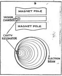
Fig. 12 .- The basic details of the Microtron.
