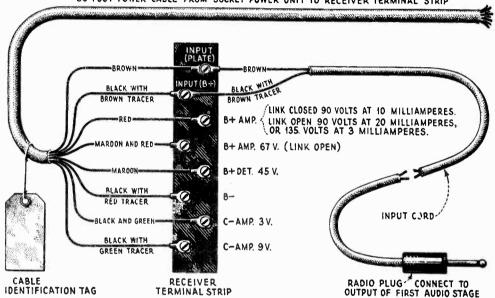
30 FOOT POWER CABLE FROM SOCKET POWER UNIT TO RECEIVER TERMINAL STRIP
