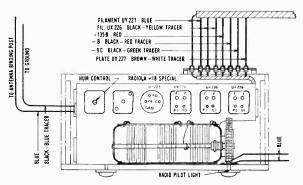
Fig. 1-Radiola Sockets and Terminal Strip
